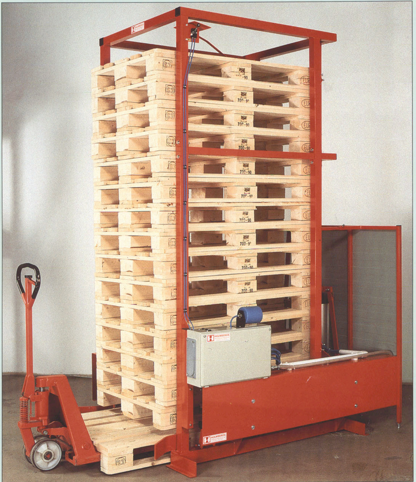
Pallmagasin BU-ST med utmatnings- och staplingsfunktion
