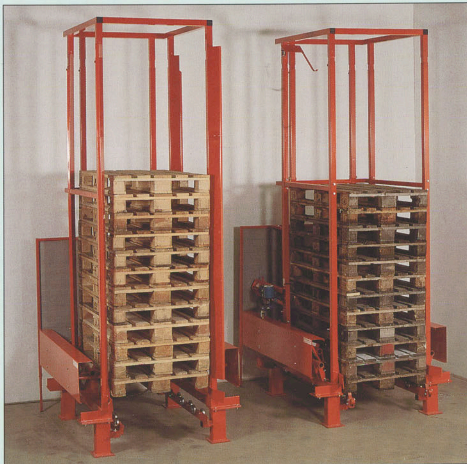
Pallmagasin typ BU-G t v med genommatning på rullskenor av rena pallar till emballeringslinje. T h BU-ST-G som staplar utsorterade smutsiga pallar för interna användning.
